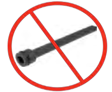
ABBILDUNG 9 – Verlängerung des Antriebsvierkants
