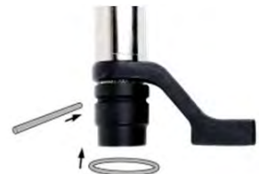
RYSUNEK 16 — Mocowanie nasadki
