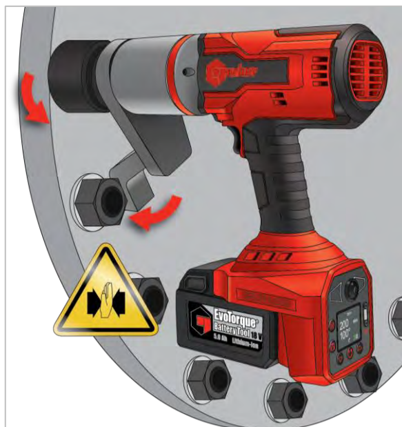
FIGUR 19 -Drift mot klokken
