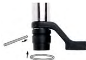
ILUSTRACIÓN 18 - Sujeción del dado
