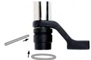
ILUSTRACIÓN 16 - Sujeción del dado
