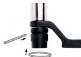
RYSUNEK 18 — Mocowanie nasadki
